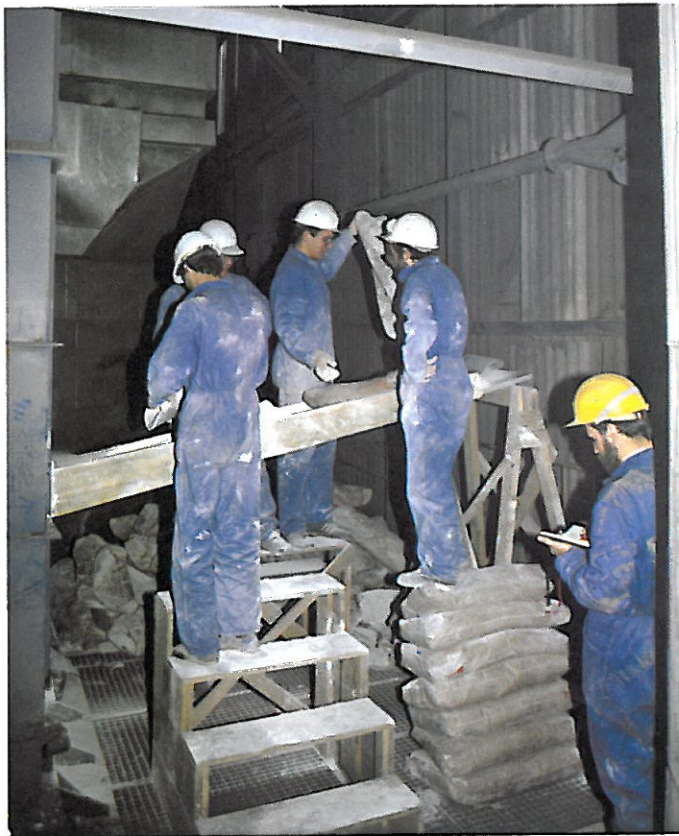
Slika A: Začetni poskusi odžveplovanja dimnih plinov z ročnim doziranjem aditiva
