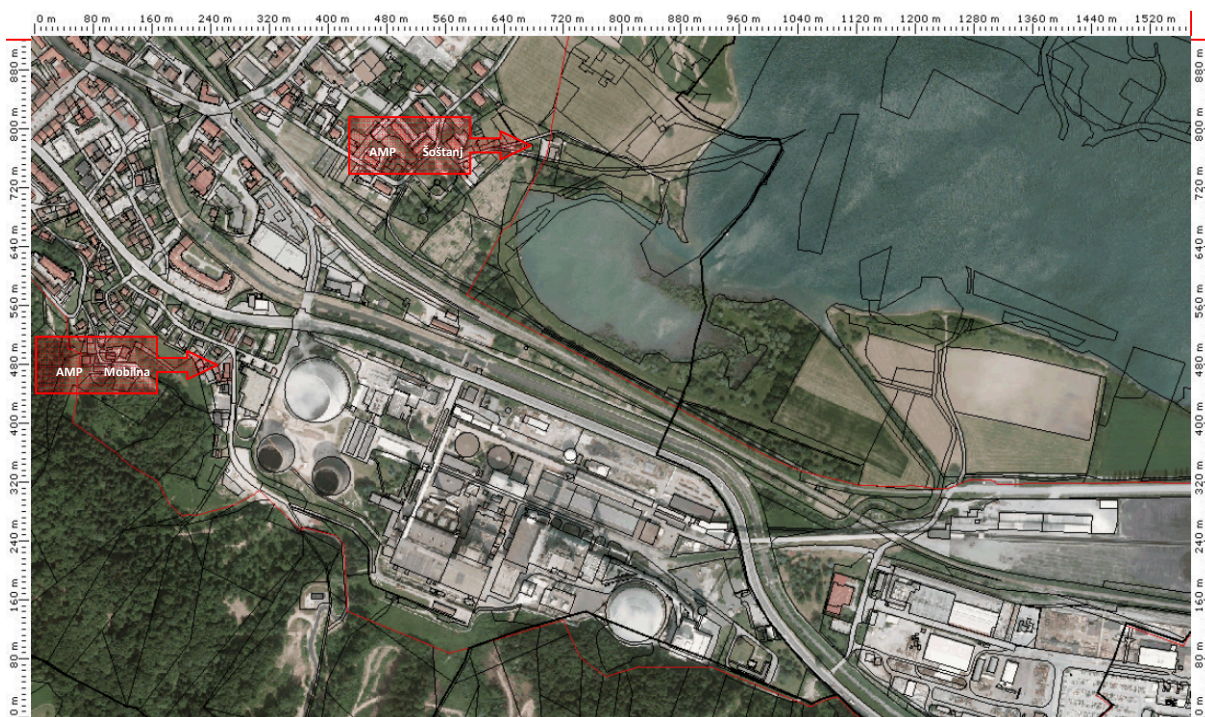
Slika 2: Lokacije merilnih mest neprekinjenega monitoringa hrupa
